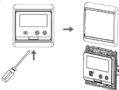
2. Используя отвертку снимите заднюю крепежную пластину.
