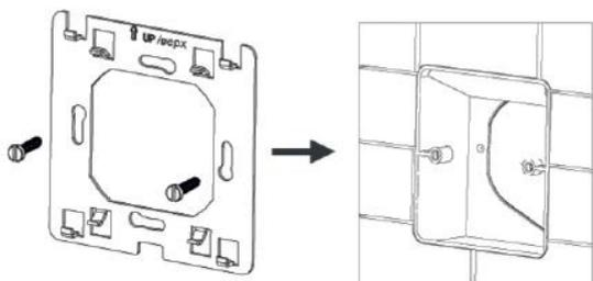
4. Подключите провода и закрепите устройство на крепежной пластине, установите обратно лицевую панель и рамку
