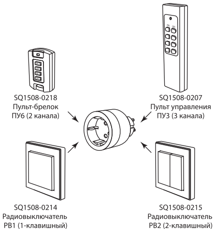
Рисунок 2. Подключение приемников P1, P2K, P3K к пультам и радиовыключателям
