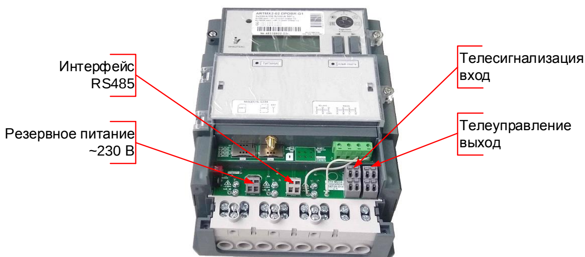
Рисунок 5.5 – Элементы подключения счетчика «Меркурий 234» с индексом «Х»
