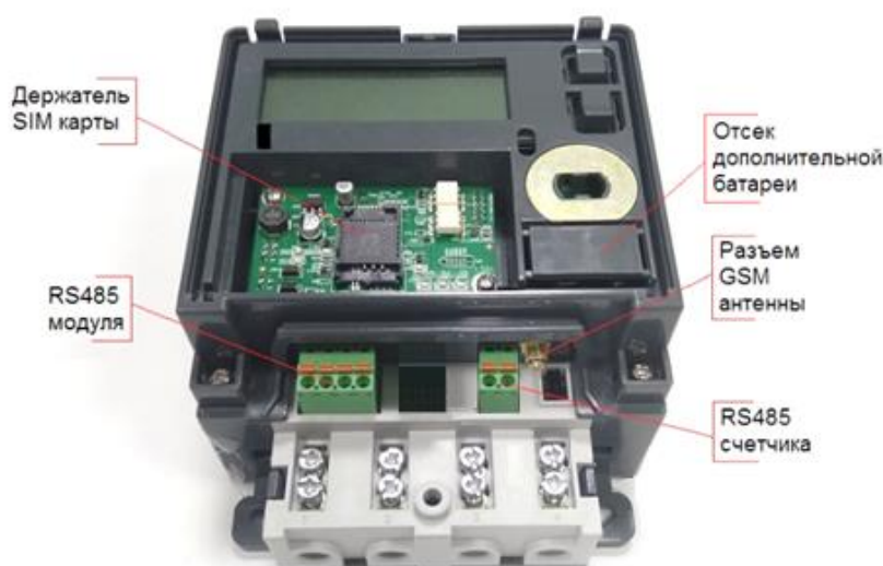
Рисунок 5.4 – Элементы подключения счетчика «Меркурий 204»
