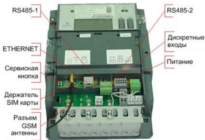
Рисунок 5.6 Элементы подключения модуля телемеханики
