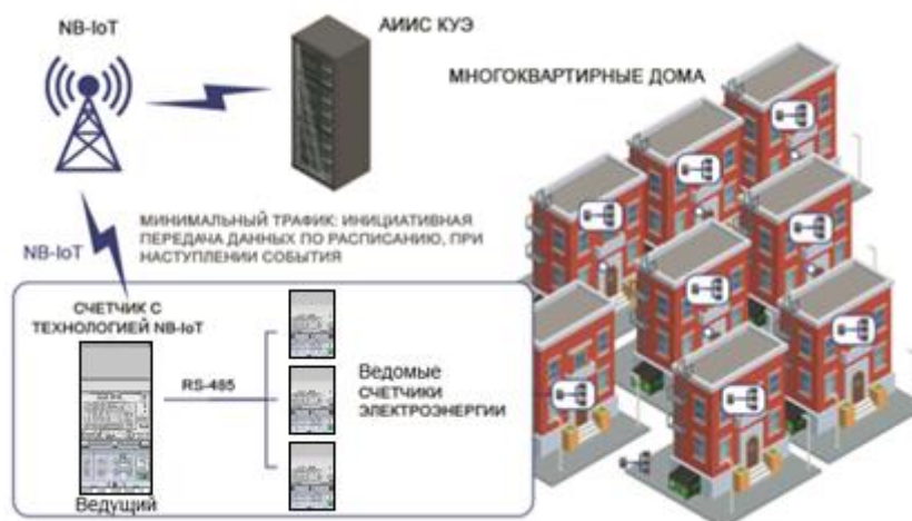
Рисунок 5.2 – Схема работы счетчика NB-IoT в составе АИИС КУЭ
