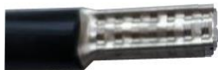
Рисунок 6.1 – Обжим провода СИП наконечником НШВ 16-18
