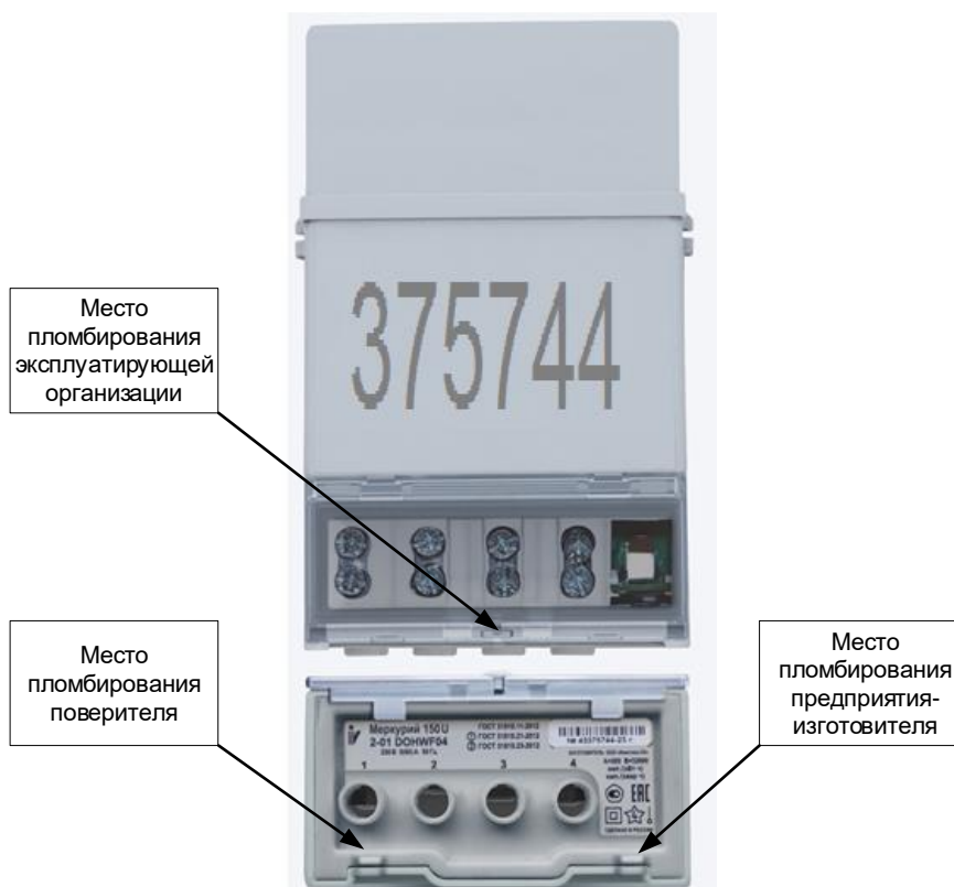
Рисунок 4.2 – Вид счетчика Меркурий 150U с указанием мест пломбирования
