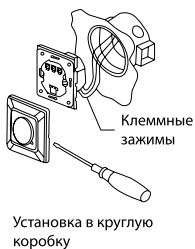
Рисунок 10. Схема монтажа датчика ДДМ-05В
