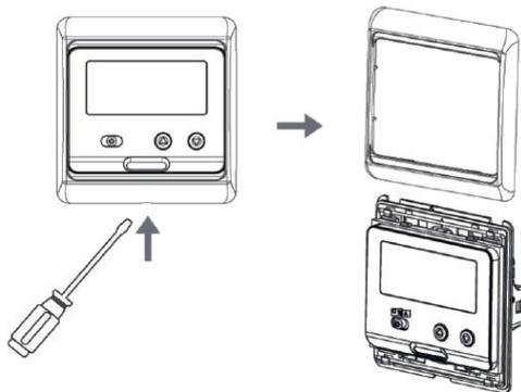
2. Используя отвертку снимите заднюю крепежную пластину.
